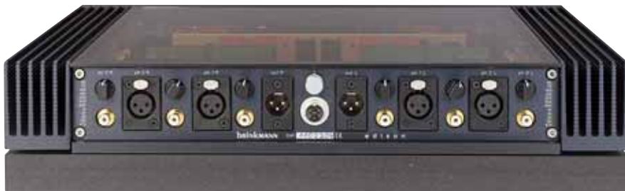
Der Abschlußwiderstand ist feinstufig anpassbar, die Anschlussvielfalt beeindruckend
