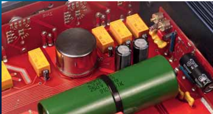
Das silberne Töpfchen ist einer der beiden hochwertigen Übertrager
