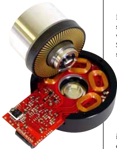
Der Brinkmann-Motor ist ein veritables Stück Hightech und wurde eigens als Plattenspielerantrieb entwickelt
