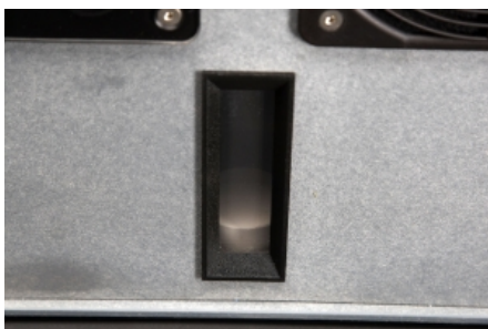
DAS SCHAUGLASS FÜR DEN FÜLLSTAND: DER SCHWIMMER AM BODEN ZEIGT, DASS FÜR DIE FOTOS KEINE REINIGUNGSFLÜSSIGKEIT EINGEFÜLLT WURDE
