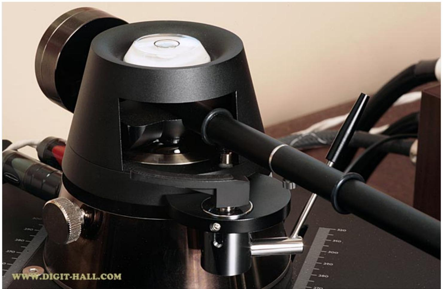
*On aperçoit ici la coupelle inférieure recevant l'huile qui forme un anneau liquide autour de l'axe du bras. Sur le côté de celui-ci on peut voir l'une des deux masselottes d'équilibrage. La molette de gauche sert au réglage de la hauteur du bras, alors que la fine molette visible sous le tube de bras est utilisée pour l'ajustement de l'azimut.*
